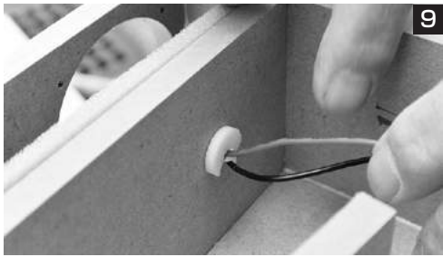
9 配線コードを通した音道仕切り板3の穴に付属の丸い目止めテープを貼って隙間を埋める
