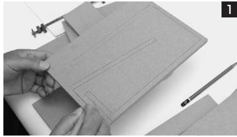
1 片方の側板に板の取付け位置が野書きされているので鉛筆などでなぞると見やすくなり作業性がよくなる
