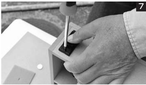
7 最後の側板取付け前に配線処理。付属の入力ターミナルにファストン端子の付いた内部配線コードを接続してから木ネジでターミナルを固定する
