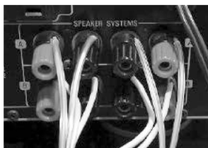
入力信号はメインシステムのアンプのスピーカー出力から取る(スピーカー側でも可)
