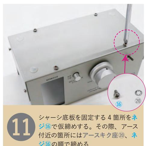
**11** シャーシ底板を固定する4箇所をネジ⑯で仮締めする。その際、アース付近の箇所にはアースキク座⑰、ネジ⑯の順で締める
