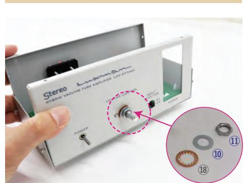
**9** フロントパネルから出たボリューム軸にボリュームアースキク座⑰、ワッシャー⑯、六角ナット⑪の順で固定する（六角ナットはラジオペンチやレンチで締める）
