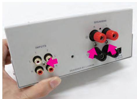
**5** シャーシのリアパネル④をあてがい、基板上のRCA端子およびスピーカー端子を内側から手でおさえながら、ネジ⑯固定する（合計3箇所）
