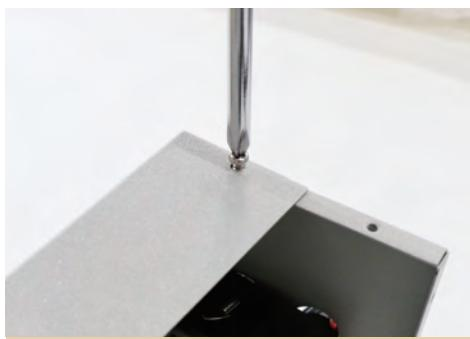
**4** リアパネル④をネジ⑯で仮締めする（両脇2箇所）
