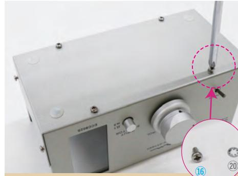
**11** シャーシ底板を固定する4箇所を**ネジ⑬**で仮締める。その際、アース付近の箇所にはアーススキ座⑳、**ネジ⑬**の順で締める
