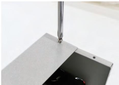
**4** **リアパネル④**を**ネジ⑬**で仮締める(両脇2箇所)
