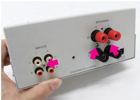
**5** シャーシの**リアパネル④**をあてがい、基板上的RCA端子およびスピーカー端子を内側から手でおさえながら、**ネジ⑬**固定する(合計3箇所)
