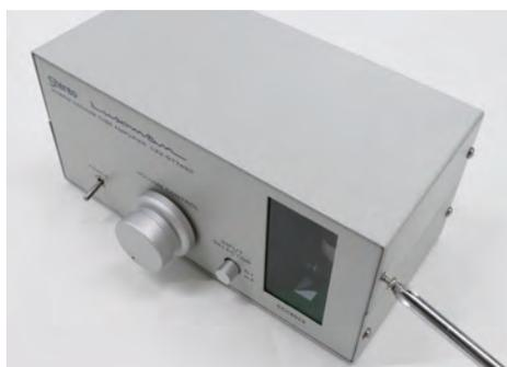
**13** シャーシ天板②をかぶせ、ネジ⑬で仮締めする（両脇4箇所）。シャーシにズレがないか確認し、これまで仮締めしていたすべてのネジを本締めする
