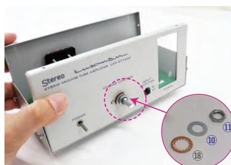
**9** フロントパネルから出たボリューム軸にボリュームアーススキ座⑱、**ワッシャー⑩**、**六角ナット⑪**の順で固定する(六角ナットはラジオベンチやレンチで締める)
