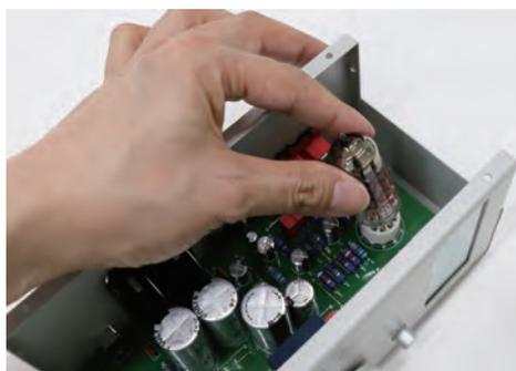
**12** 真空管②をソケットに左右に少しずつ振りながら慎重に差し込む
