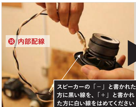
18 内部配線をスピーカーユニット「OM-MF519」（別売り）に装着し、 14 スピーカー取付用ネジで取り付ける。スピーカーを取り付ける際、ドライバーでスピーカーユニットのコーンを傷つけないように手で押さえながら取り付けてください。
