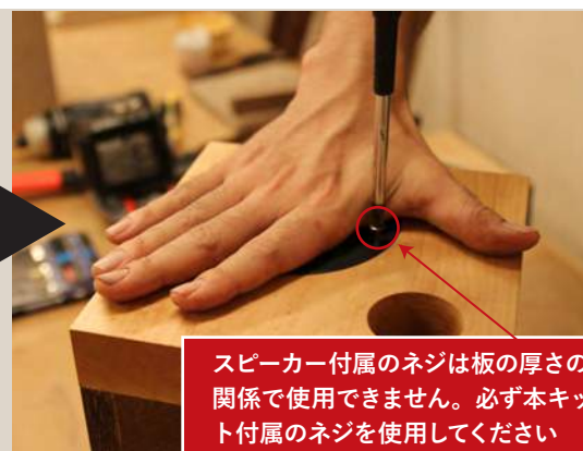
18 内部配線をスピーカーユニット「OM-MF519」（別売り）に装着し、 14 スピーカー取付用ネジで取り付ける。スピーカーを取り付ける際、ドライバーでスピーカーユニットのコーンを傷つけないように手で押さえながら取り付けてください。
