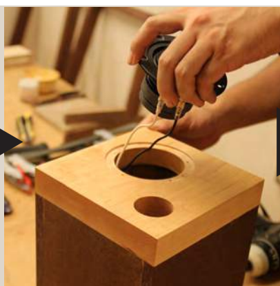
18 内部配線をスピーカーユニット「OM-MF519」（別売り）に装着し、 14 スピーカー取付用ネジで取り付ける。スピーカーを取り付ける際、ドライバーでスピーカーユニットのコーンを傷つけないように手で押さえながら取り付けてください。
