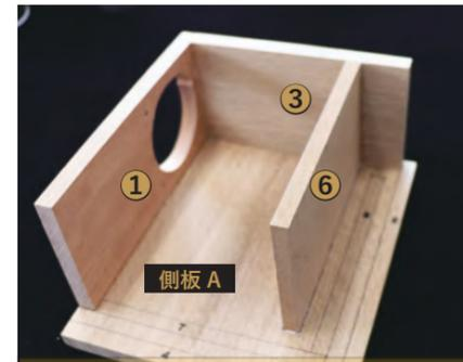
[4] T 字パーツの接着面にボンドを塗り、接着する。
