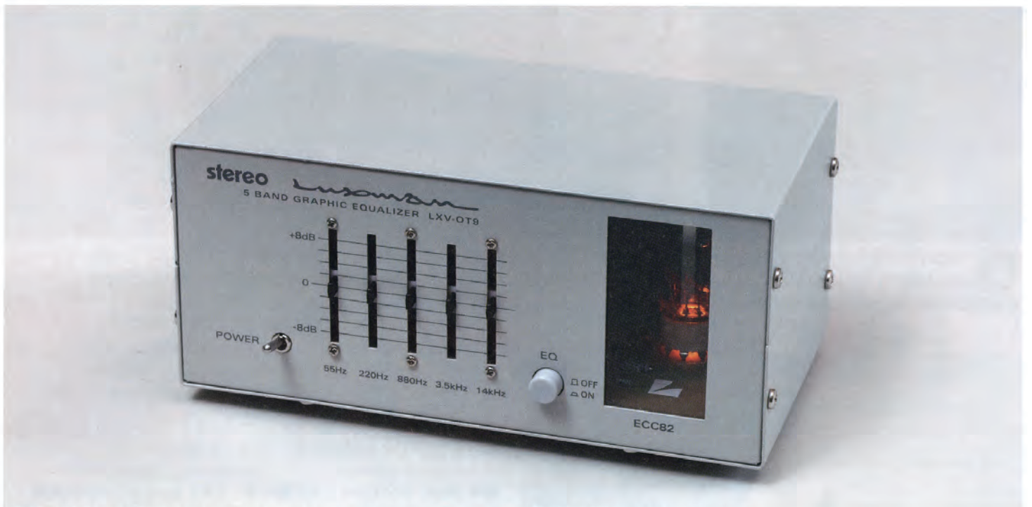
14 ACアダプター⑭を差し込んで電源スイッチ (POWER) を入れ、照明ランプが点灯したらキットは完成。さっそく接続して動作確認してみよう
