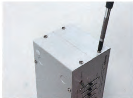
12 シャーシ天板①をかぶせ、ネジ⑫で4カ所を仮締めし、最後に全てのタッピングネジを本締めする
