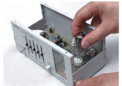
11 真空管⑥をソケットにピン位置を合わせて奥まで差し込む
