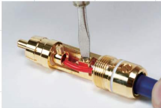
10 | ケーブル固定ネジ、アース(白)、ホット(赤)の順にネジを締めていく
