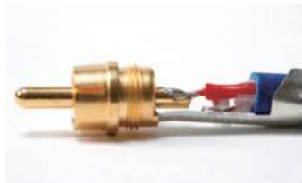
ハンダ付け完了。横から見た写真
