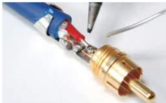
プラグによってケーブルをカットする長さが異なる。ハンダ付けの際、ホットとアースが触れてショートしないように注意する
