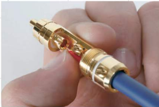
9 | アース(白)を手前の端子穴に、ホット(赤)を先端の端子穴に爪で曲げながら同時に入るようにケーブルを挿入していく
