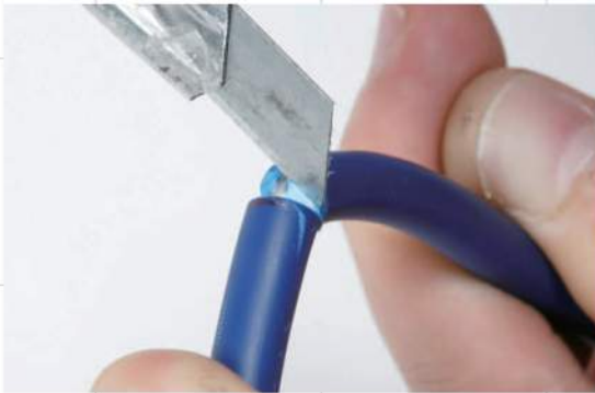
3 | 切り目から曲げながら、刃先でこするように切れば内部の線に傷をつける失敗がおきにくい
