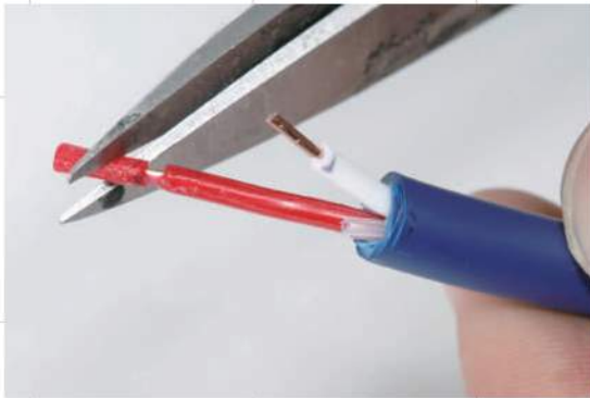
7 | ホット(赤)を先端から7mm、アース(白)を先端から5mm、切り目を入れて絶縁を剥く。このとき導体に指で触れないように注意
