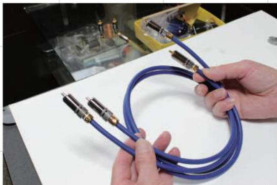
この工程を4箇所行なえば完成。音が出ない場合、ケースを開けてホット(赤)、アース(白)がプラグにきちんと接続されているか、ショートしていないかを確認
