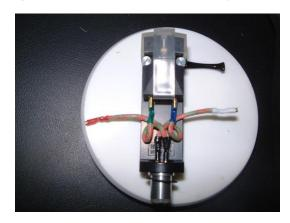
③できるだけ、ワイヤーに負荷がかからないよう慎重に回転させながら、正しいピンの位置に接続する。
