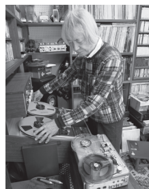
石田氏所有のナグラIV-SとスチューターA810を接続し、マスターテープからダイレクトにコピー。録音ごとにヘッドのクリーニング、バイアス調整を行なう
