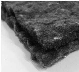
キヨトマモル氏秘蔵のフェルト系ヴィンテージ吸音材が付属。1970年代日本製の吸音材は、柔らかく調整しやすい
