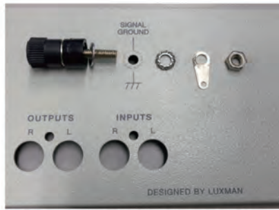
11 アース端子⑩を写真のように分解する。シャーシ外側が端子、ワッシャー、内側がキク座、卵型ラグ、ナットの順になる
