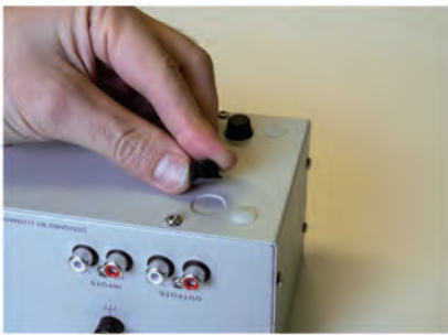
15 ゴム脚⑧を底板の窪みに合わせて貼る
