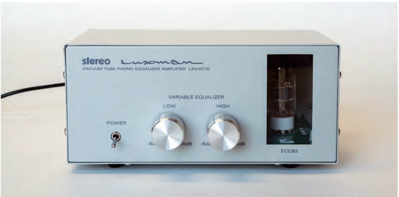
16 ACアダプター⑮を差し込んで、電源スイッチを入れ、照明ランプが点灯したらキットは完成。さっそく接続して動作確認してみよう
