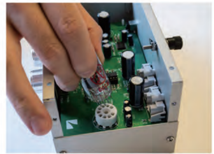
13 真空管⑥をピンとソケットの向きに合わせて差し込む
