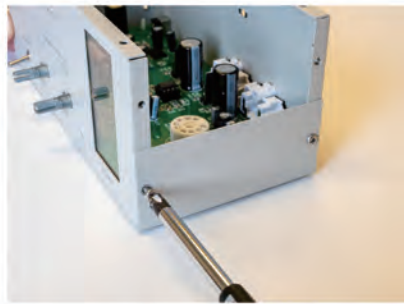
14 天板①をかぶせ、ネジ⑭で締め、全てのネジを本締めする
