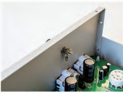
12 外側から端子を抑えながら、⑩のナットをラジオペンチでしっかり締める
