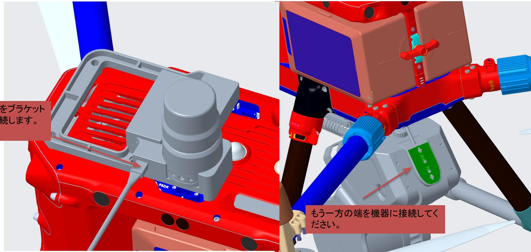
注意: 外部電源ケーブルの両端を接続した後、ケーブルを機体に固定してください。
