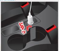
①車体取付用の粘着付面ファスナーを、プラグ差 込口の左右に取付けます。
