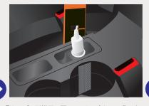
②ケーブル引掛用の面ファスナー (オレンジ)の切 り込み部分を、プラグに通します。プラグ側か らケーブル固定用面ファスナー (クロ) のスリッ ト部分にケーブルを入れるようにして取付け、 ケーブルを固定します。
