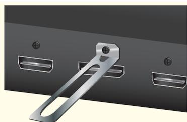
①ポート上部の既存のネジを外してガイドを取り付けます。
