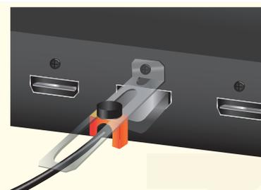
③ガイドの溝へフックを入れてプラグにあわせて、フックネジ部にワッシャーを入れてナットで固定します。
